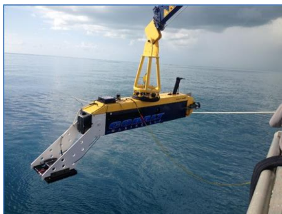
HAUV Dolores with Gen-1 EM array
